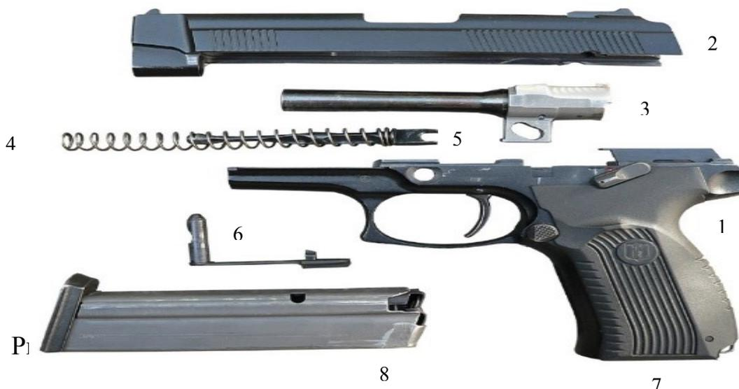
1 – рамка со спусковой скобой, ударно-спусковым механизмом, предохранителем и защелкой магазина; 2 – затвор с ударником, прицельным приспособлением и выбрасывателем; 3 – ствол; 4 – возвратная пружина; 5 – шток; 6 – замыкатель; 7 – рукоятка; 8 – магазин.
